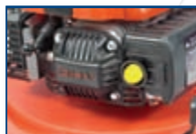
Cebador para arranque en frío Primer button for cold start
