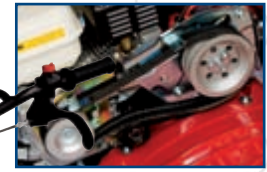
Doble correa transmisión en MTZ 500H Double belt in MTZ 500H model
